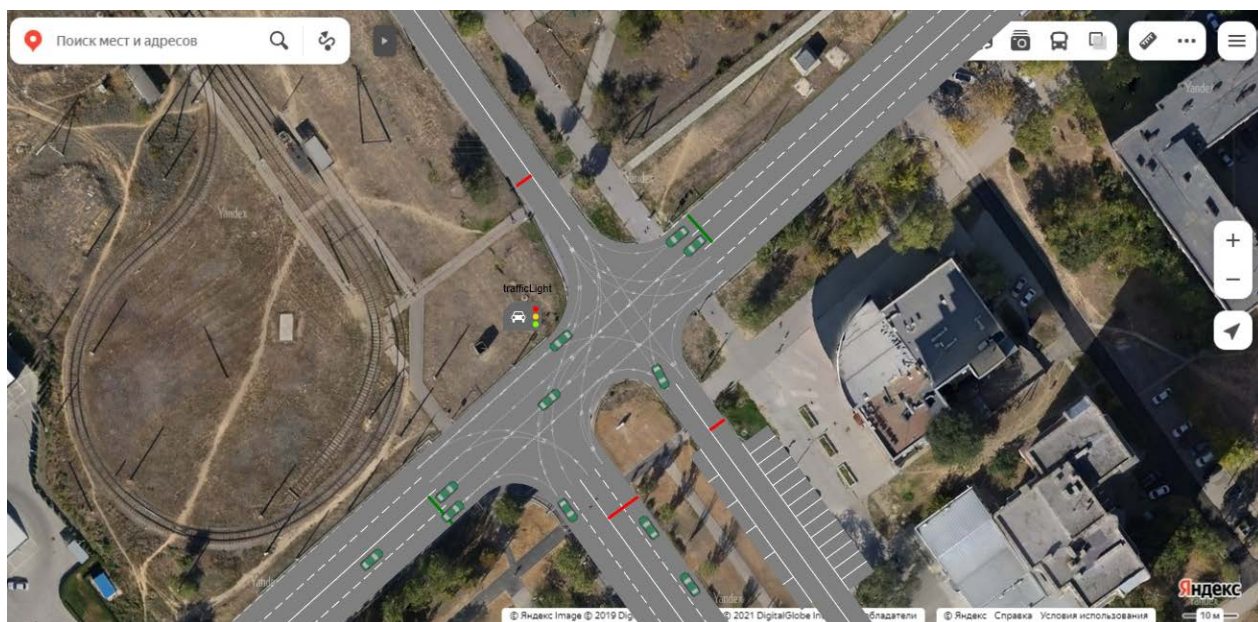
Рисунок 4 – Наложение фактического режима движения на перекресток в имитационной модели
